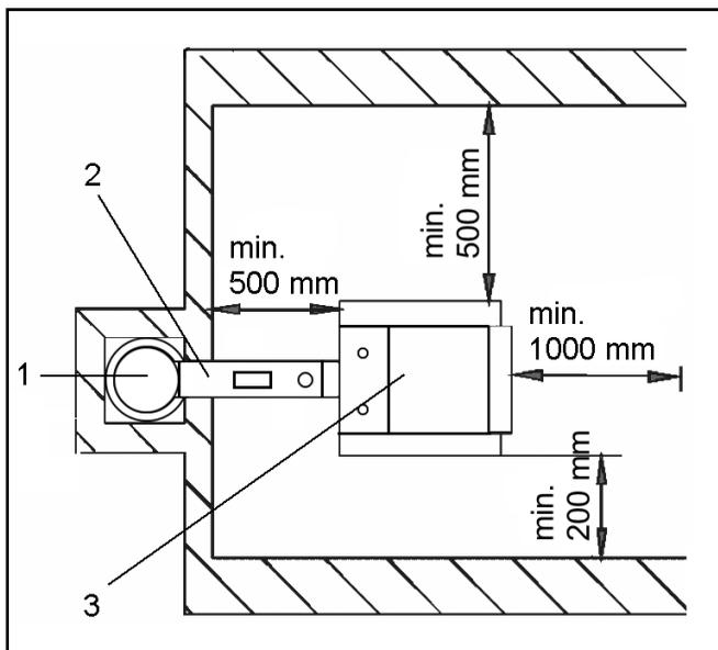
Kessel müssen in einem Kesselhaus aufgestellt werden, in den ausreichender für die Verbrennung erforderlicher Luftzutritt sichergestellt wird. Es ist unzulässig, Kessel im Wohnraum (einschl. Gänge) zu installieren. Der Querschnitt der Öffnung für Verbrennungsluftzufuhr in den Kesselhaus muss für Kessel mit Leistungen von 18 – 49 kW mindestens 250 cm<sup>2</sup> betragen.
