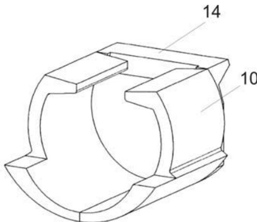
Der Formstein (kugelförmiger Raum) muss so zusammengesetzt werden, dass der Vorderteil des Formsteins 3 cm von dem vorderen Kesselteil entfernt ist.
