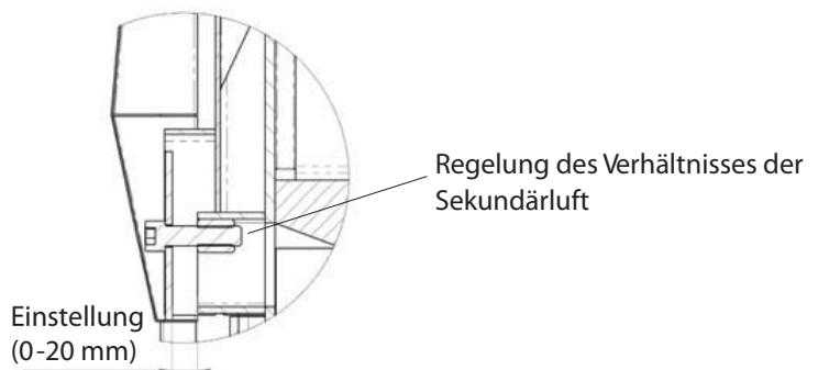
Die tatsächliche Einstellung ist durch einen Abgasanalysator an gegebene Bedingungen anzupassen. Unter Einstellung versteht sich das Herausziehen der Reglerzugstange.
